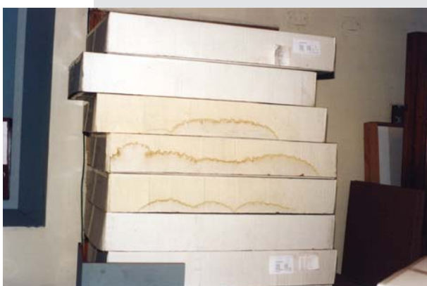
Ondulaciones producidas en el textil, producto de absorción de humedad del medio ambiente.
