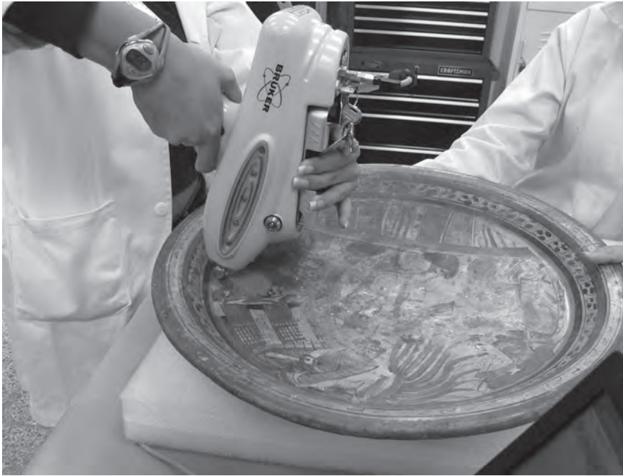
FIGURA 4. Análisis elemental por espectrometría de fluorescencia de RX en una cerámica maya (Fotografía: Carmen Noval 2013; cortesía: CNCPC-INAH).
