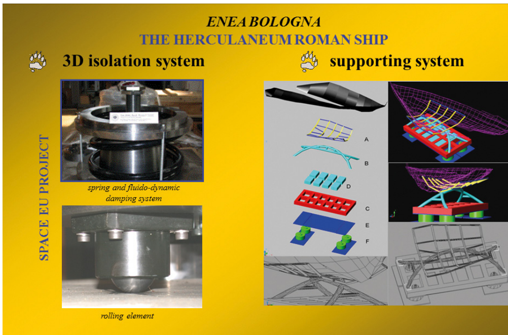
Figura 14: O Barco Romano de Herculano: sistemas de isolamento e suporte em 3D.
