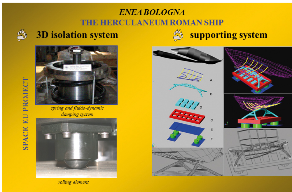
Figura 14: La barca romana herculana: sistemas de soporte y aislamiento 3D.
