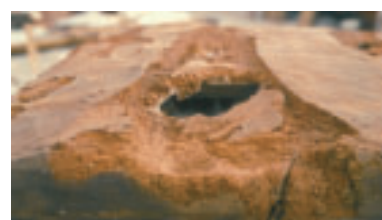
Retablo de Santa Eulalia, Marquínez: Efecto de la destrucción causada por la termita.
