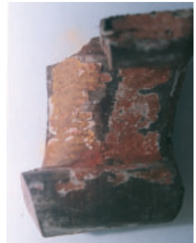
Detalle del ataque de insectos xilófagos en uno de los paneles del altar.
