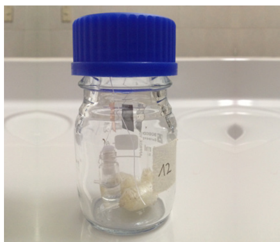
Figura 2. Frasco de análisis, test de Oddy (Fotografía: Araya, C. 2015).
