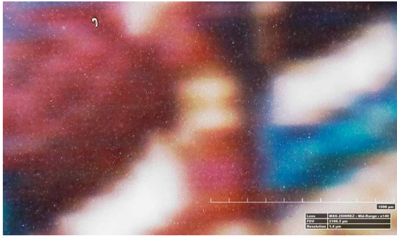
Figura 3. Detalle de una copia imprimida por sublimación de colorantes vista al microscopio [140x]. Se muestra el característico tono continuo, la ausencia de grano y de contornos nítidos y la presencia de un moteado, en este caso blanco, provocado por polvo que quedó atrapado entre la banda transportadora de tintes y el papel durante la impresión (Jürgens, 2009: 174). Fotografía: Rosina Herrera Garrido.
