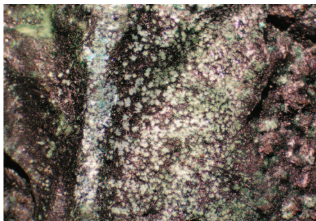
Fig. 27 La atacamita, como el resto de los cloruros de cobre, reacciona rápidamente y de una manera dramática en las superficies metálicas. Aquí se muestra en asociación con paratacamita.
