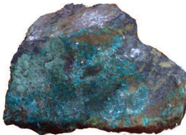
Fig. 43 Aparece frecuentemente en bronce al exterior, en zonas protegidas donde se han depositado yesos.
