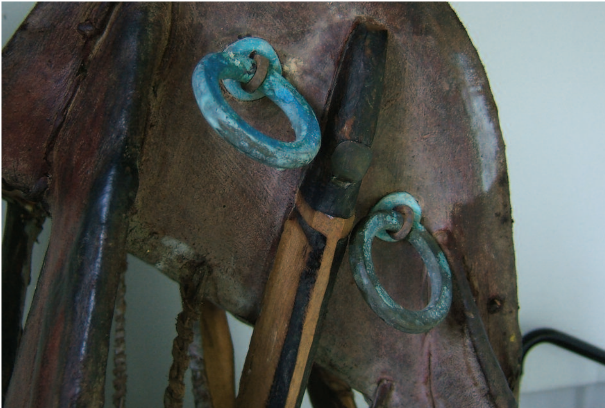
Fig. 56 Silla de montar de cuero con elementos de sujeción en aleación de base cobre alterados por las emisiones de gases orgánicos del proceso de curtido.
