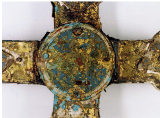
Fig. 20 Depósitos de calconatronita sobre un latón esmaltado. La alteración aparece en las áreas donde el esmalte se ha perdido y en las zonas de las paredes de separación entre esmaltes.
