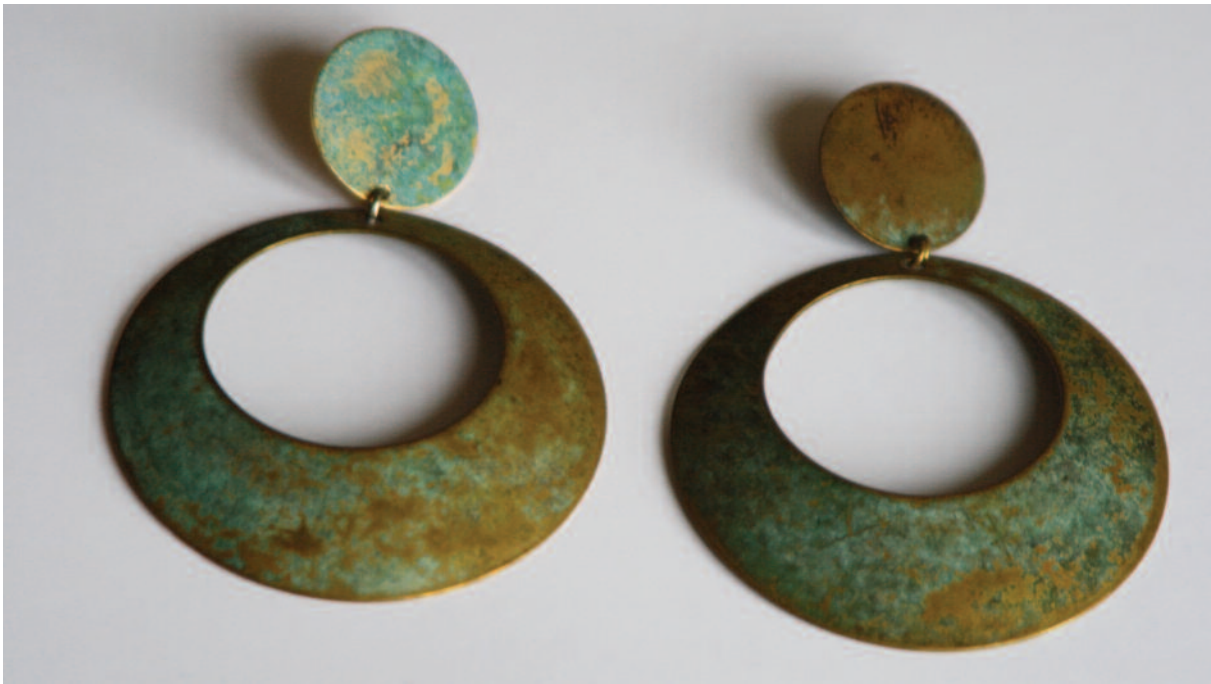
Fig. 57 Depósitos verdosos de acetato de cobre.
