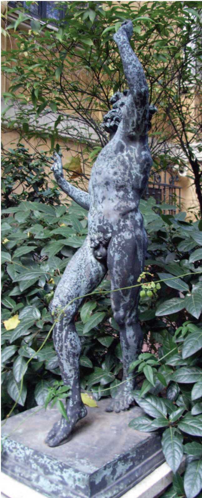
Fig. 37 Formación de "islas" de alteración negra rodeadas por alteración de brochantita en las esculturas expuestas al exterior.
