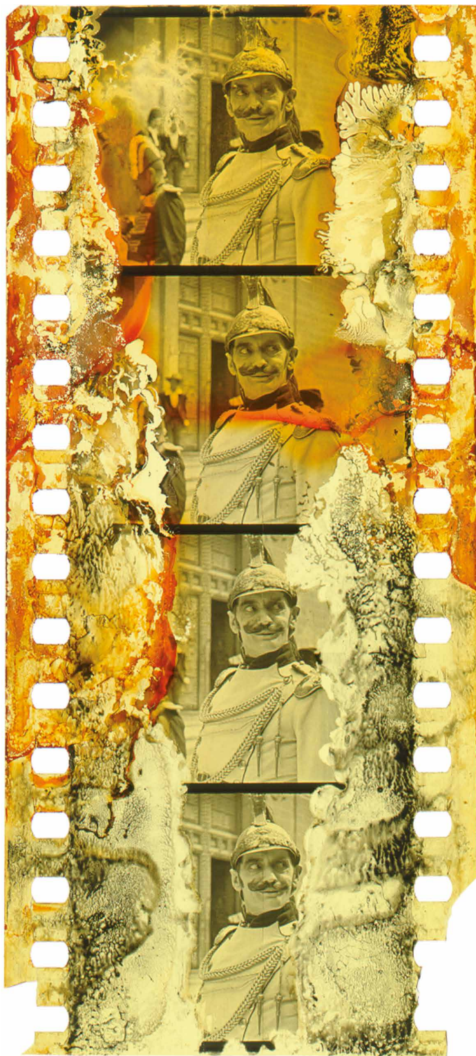
Fotogramas de película muda severamente afectados por descomposición química del celuloide. Fotografía: Filmoteca Española.
