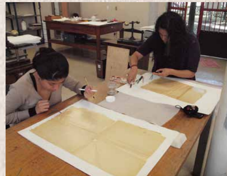
Figura 6. Proceso de estabilización de los fragmentos del plano, mediante la aplicación de refuerzos de papel japonés preparado con Klucel® G. (Departamento de Conservación y Restauración, AGN, 2012)
