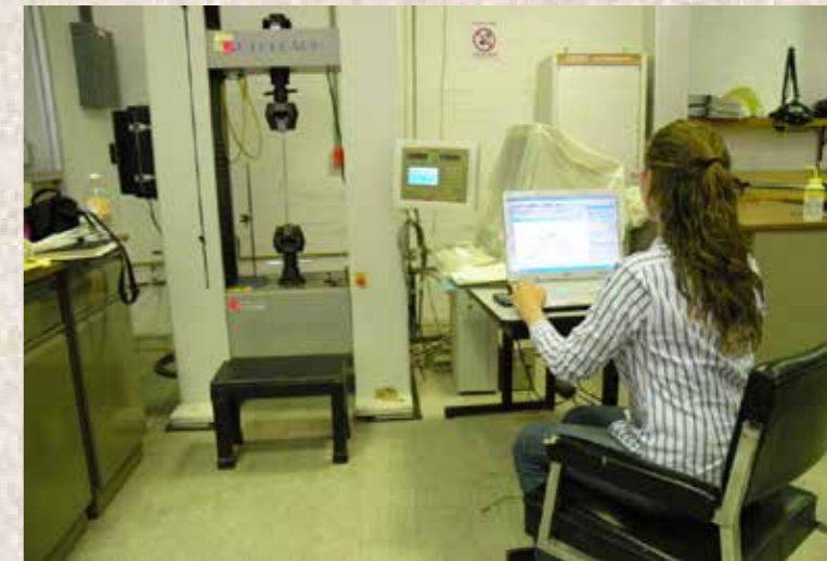
Figura 2. Máquina AUTOGRAPH SHIMADZU AG-100KNG, del Instituto de Física de la UNAM
