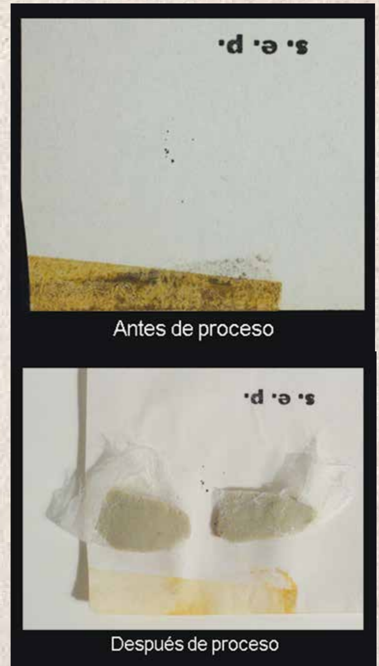
Figura 11. Eliminación de adhesivos con microemulsiones, NanoforArt Papel-México, 2013
