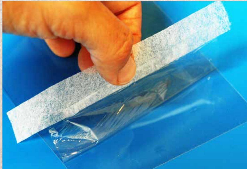
Imagen 3. Realización de las películas secas de adhesivo, abril 2013, foto: Nadine Vera
