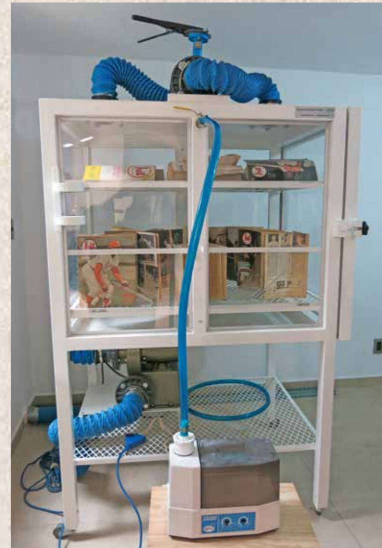
Figura 6. Cámara de fumigación Ex Libris
