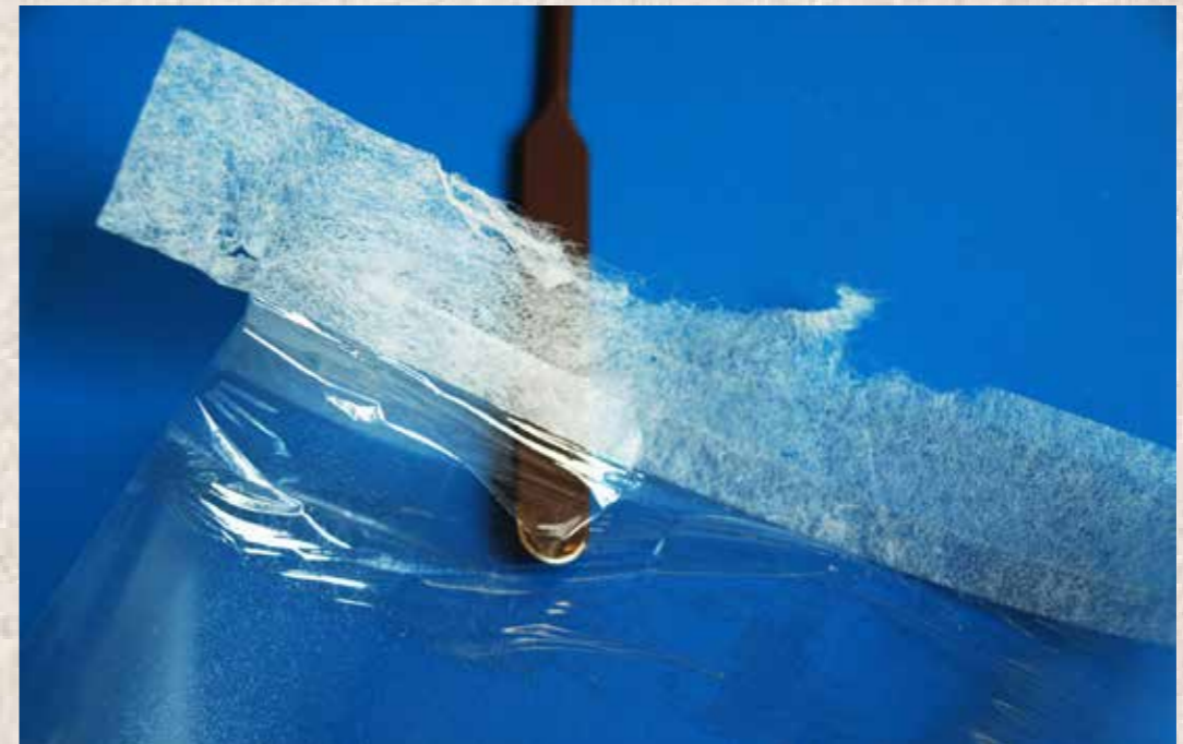
Imagen 2. Realización de las películas secas de adhesivo, abril 2013, foto: Nadine Vera
