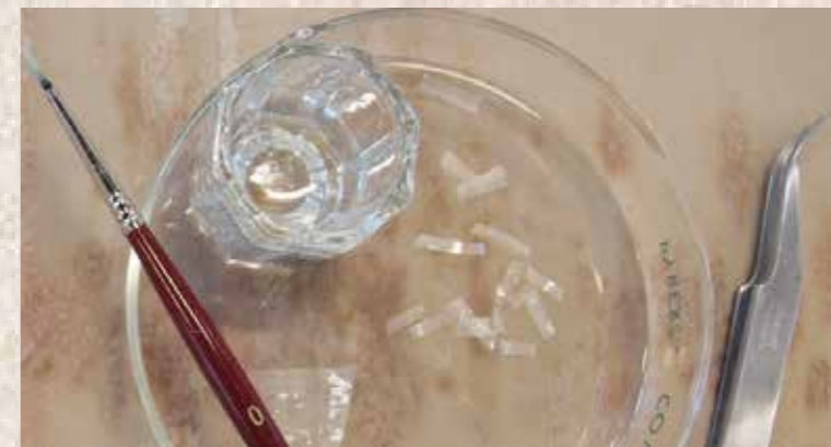
Figura 5. Detalle de refuerzos de papel preparado con Klucel® G para reactivar, similares a los utilizados en el plano. (Departamento de Conservación y Restauración, AGN, 2012)
