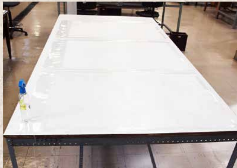
Figura 7. Preparación del papel japonés para el laminado con Klucel® G reactivado. (Departamento de Conservación y Restauración, AGN, 2012)
