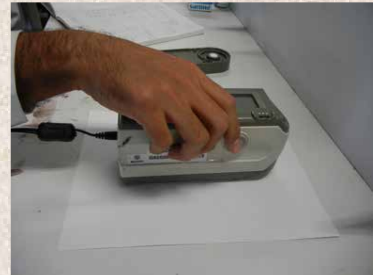
Figura 6. Espectrofotómetro de contacto CM2500d de la marca Konica Minolta®. ENCRyM
