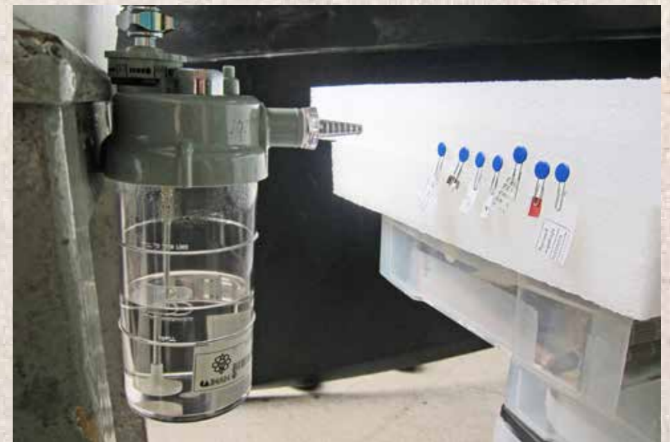
Figura 9. Aplicación directa por nebulización, NanoforArt Papel-México, 2013
