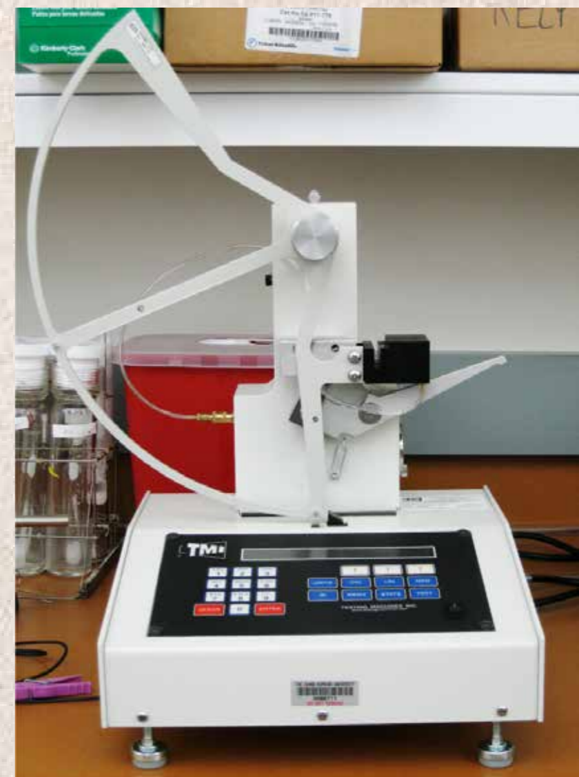
Figura 2. Equipo de rasgado Elmendorf / en el laboratorio Heritage Science for Conservation, Johns Hopkins University, 2013
