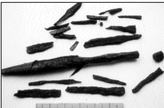
Lámina VIII: Reoxidación de un puntero romano tras varios meses después de haber sido tratado con sulfito alcalino
