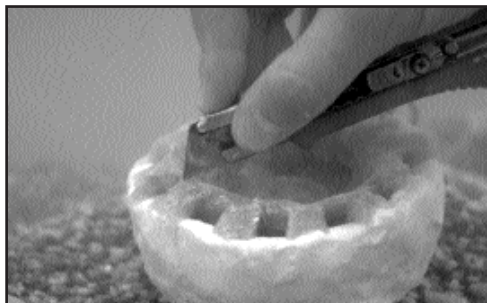
Inicialmente se crea un módulo base practicando cajas de ensamblaje sobre la resina en fase de gel consistente para ser cortado con la intervención de un cutter
