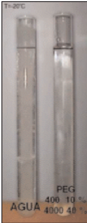
En este gráfico (Según W. R. Ambrose) se muestra la densidad de las disoluciones en el punto próximo a la congelación. Se aprecia que la diferencia de volumen es menor al incrementar la concentración
