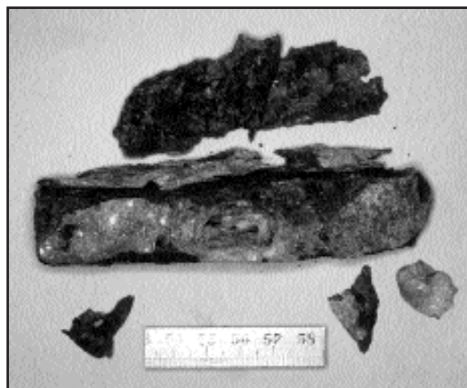
Lámina I: Alteración de un objeto de hierro por desprendimiento de lascas debido a la presión ejercida por los cloruros después de la deshidratación
