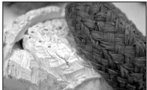
La impresión del original permanece en la cara interna del molde de silicona cuya flexibilidad le permite extraerse sin daño para el objeto
