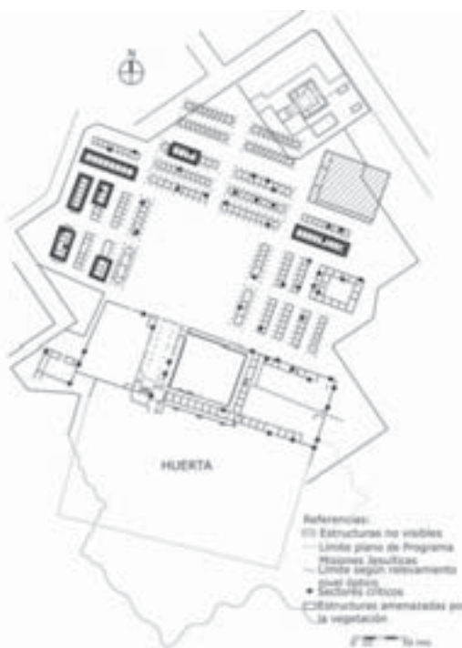
Figura 8. Mapa de riesgo estructural de San Ignacio Miní. Las zonas en riesgo estructural están marcadas con puntos o líneas negras.
