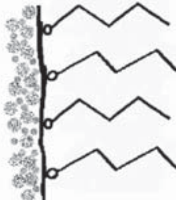
Fig 4 Esquema de un hidrofugante: la “cabeza” del silicato se adhiere a la superficie, mientras que la “cola” del radical alquilo confiere la hidrofugación.
