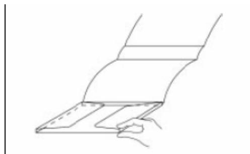
**10.** Por último, se cubre el libro con la película de poliéster, plegando las solapas de los extremos hacia la parte de adentro de las tapas anterior y posterior. Se pliegan las solapas superior e inferior y se introducen entre la superficie exterior de la tapa del libro y la película de poliéster, de forma que quedarán visibles a través de la sobrecubierta de película de poliéster.
