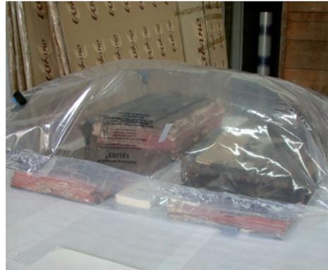
Tratamiento de desinsectación por anoxia utilizando gases inertes.
