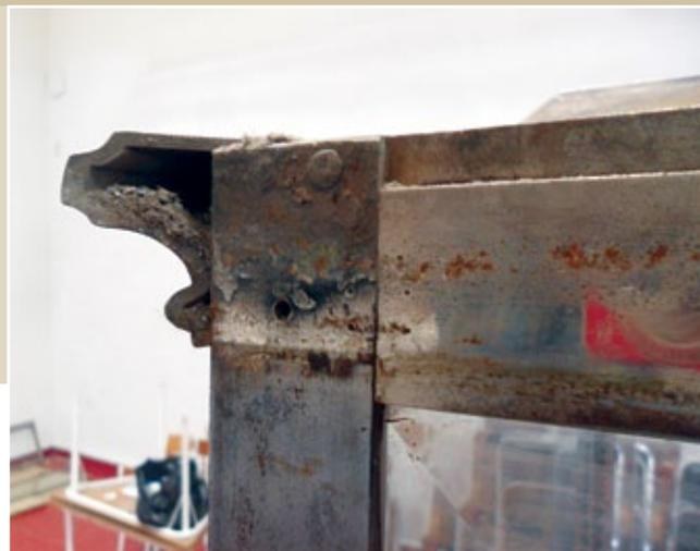
naturaleza, sufría distintos grados de corrosión (Figura 5). Se detectaron desajustes estructurales que ocasionaban separación entre los vidrios y las molduras, así como problemas en el desempeño de las bisagras y los sistemas de cerraduras. Además, los vidrios estaban sucios, tenían manchas de pintura en superficie y pequeñas zonas desportilladas.
