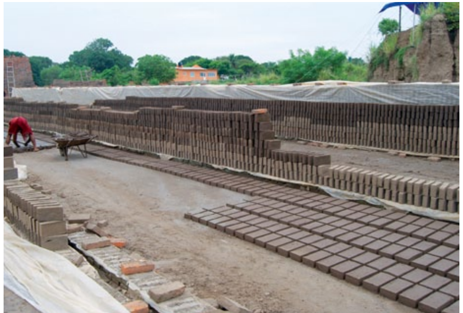
FIGURA 1. Fabricación de ladrillos con el material arqueológico. Al fondo a la derecha, vestigio arqueológico actualmente protegido mediante carpa (Fotografía: Luis Guerrero, 2008).
