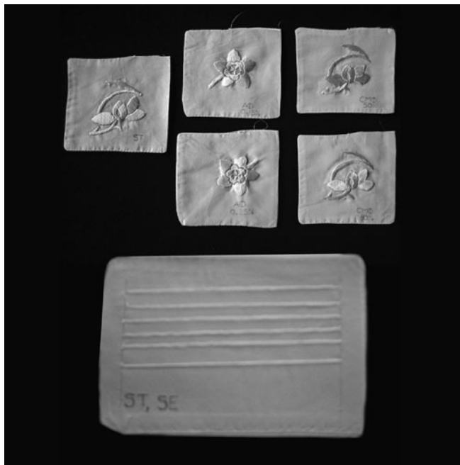
FIGURA 2. Forma en que se cosieron las probetas: para las mediciones colorimétricas y análisis MEB (sup.) Y para las pruebas mecánicas (inf.); (der.) (Fotografía: J. Contreras Vargas, 2005; cortesía Museo Franz Mayer).
