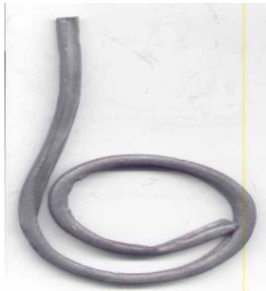
Huincha de Plomo para unir los vidrios de los vitrales
