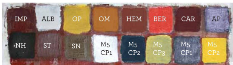
Figura 7. Apariencia de la probeta experimental una vez aplicadas la imprimación y las diferentes pinturas de pigmentos puros y mezclados utilizados en esta investigación: imprimación (IMP), albayalde (ALB), oropimente (OP), ocre de mina inglés (OM), hematita (HEM), bermellón (BER), carmín (CAR), azul de Prusia (AP), negro de humo (NH), siena tostada (ST), sombra natural (SN) y las diferentes capas pictóricas que emulan las muestras M5 (M5-CP1, M5-CP2 y M5-CP3) y M6 (M6-CP1 y M6-CP2)
