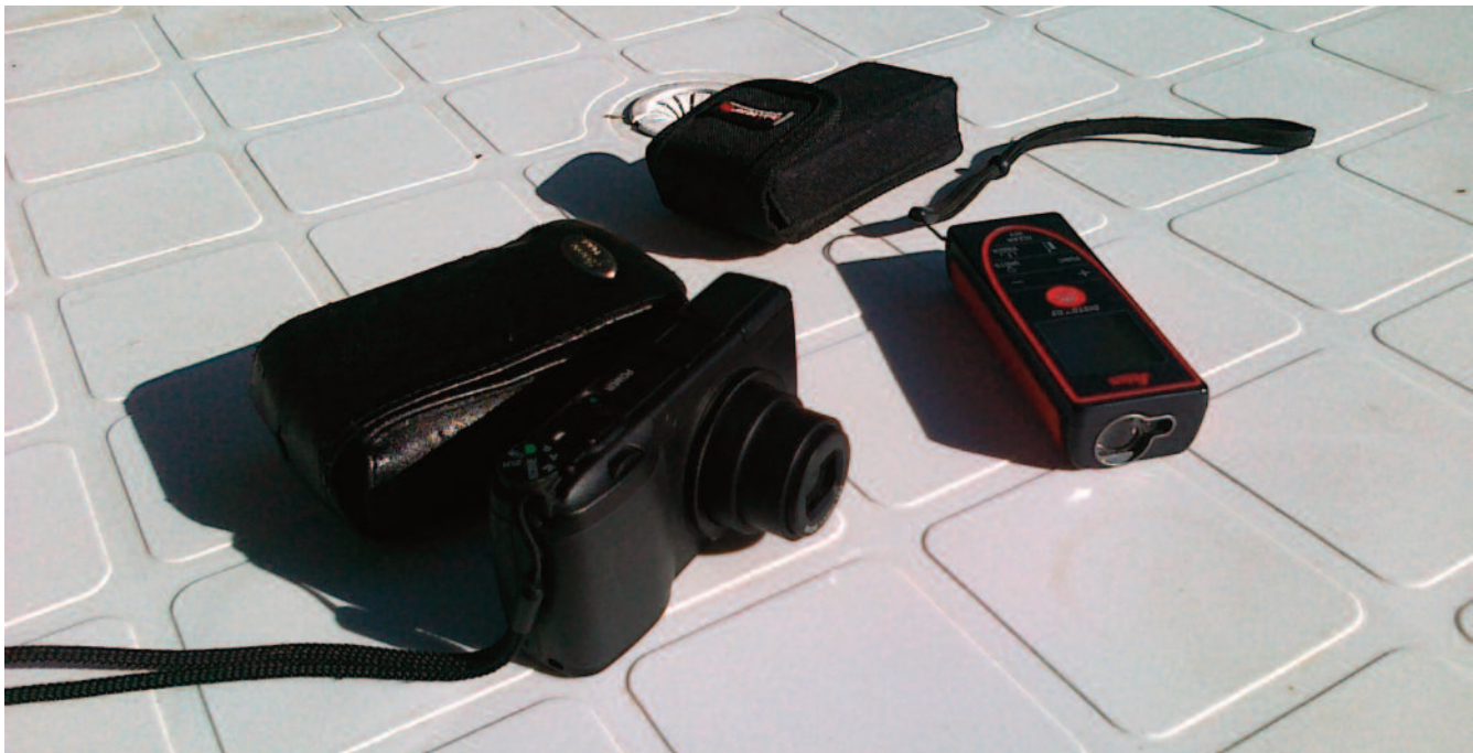
Fig. 15 Instrumentos básicos para la toma de datos para fotogrametría simple.
