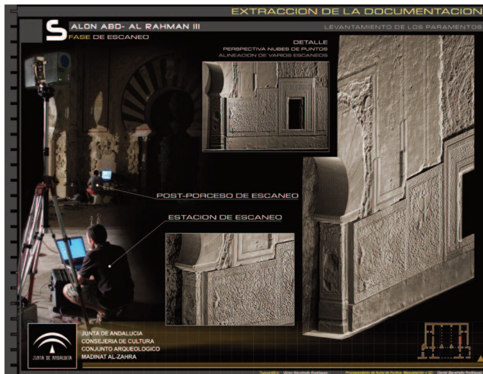
Fig. 1 Extracción de la documentación mediante escáner láser, Salón de Abd al-Rahman III en Madinat al-Zahra. Infografía realizada por Daniel Baceiredo Rodríguez.
