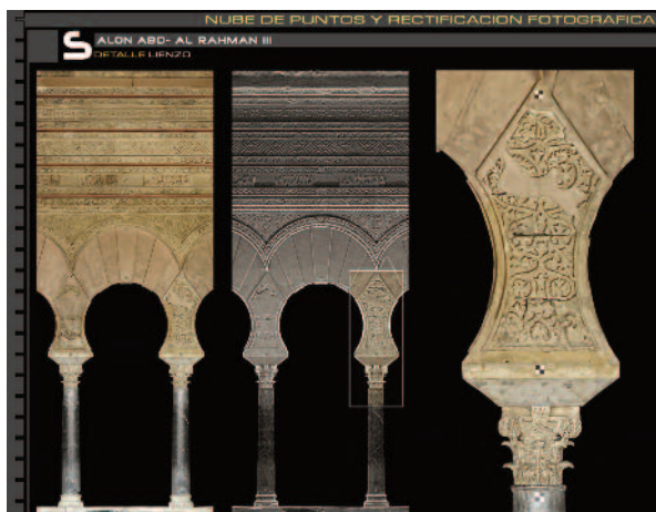
Fig. 8 Proceso de rectificación fotográfica de la ortoimagen del lienzo de cabecera de la nave longitudinal central. Salón de Abd al-Rahman III en Madinat al-Zahra. TDTEC.
