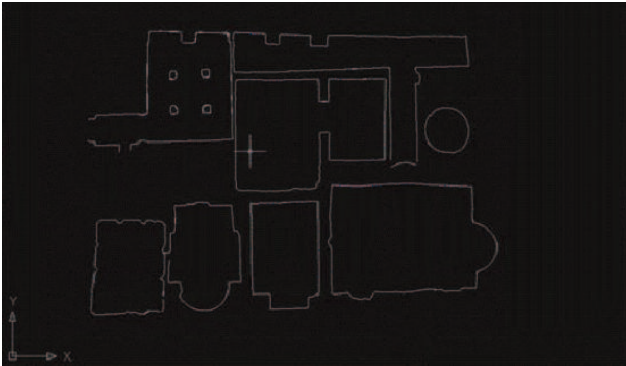
Fig. 9 Dibujo CAD, extraído de datos procedentes de escaneo por láser empleando cortes transversales, fuente http://www.deltasphere.com.v
