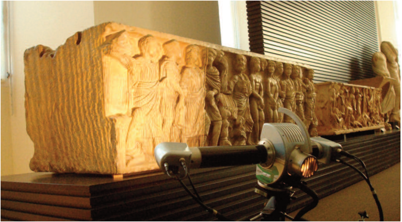
Fig. 4 Toma por scanner de luz blanca estructurada.
