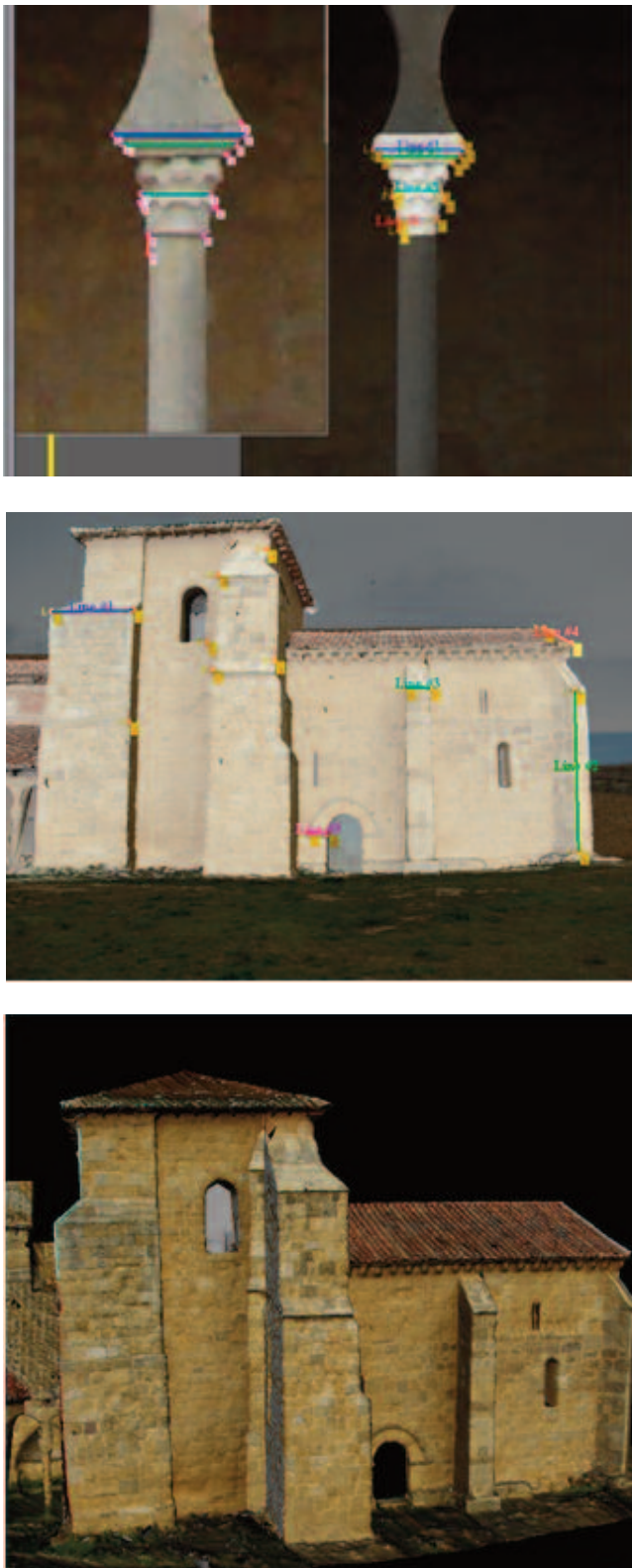
Fig. 10 En esta columna, de arriba a abajo, aplicación de la imagen, señalando puntos homólogos y resultado final.
