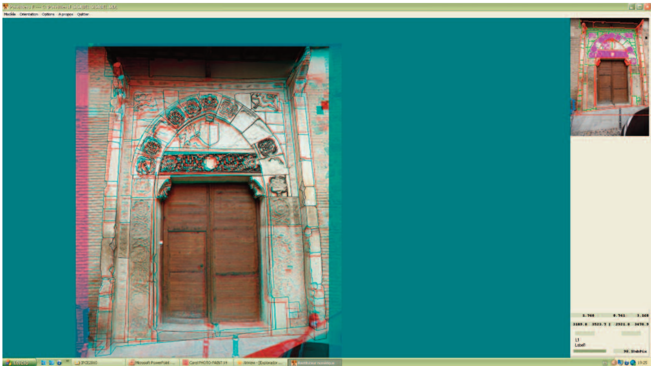
Fig. 4 Pantalla de restitución del sistema PoivilliersF con sistema de visión estéreo por anaglifos con superposición del dibujo restituído.
