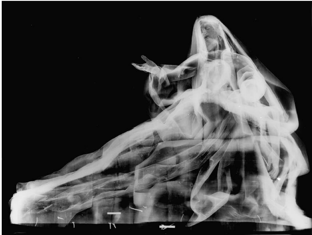
Fig. 4 Radiografía de una escultura en madera policromada hecha en una sola exposición.
