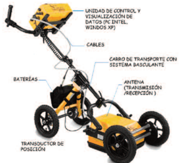
Fig. 1 Componentes de un equipo GPR (SEEKER SPR con antena 500 MHz).
