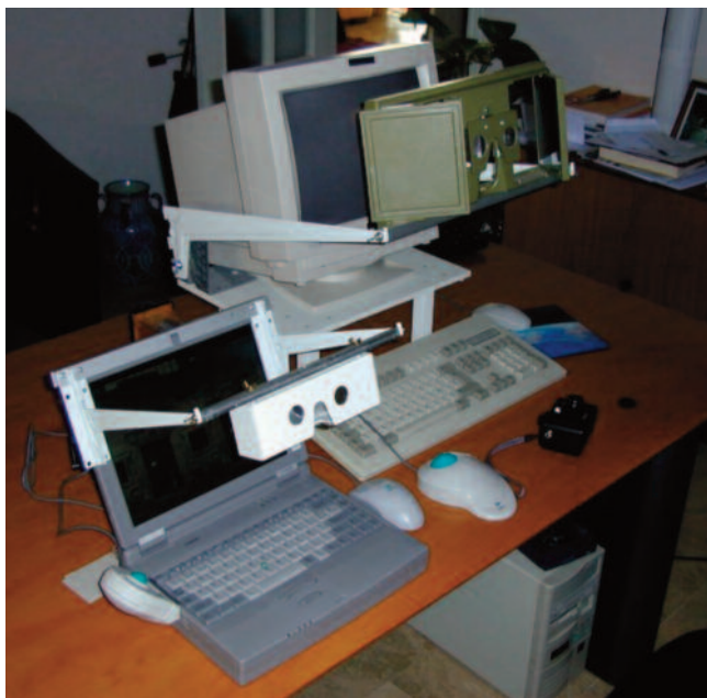
Fig. 2 Dispositivo de sobremesa y portátil para la restitución digital con el programa VSD.
