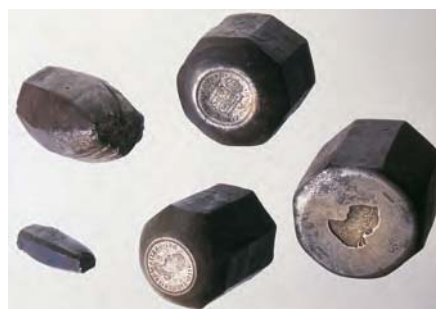
Fig. 57. Herramientas de acero para acuñar monedas.
