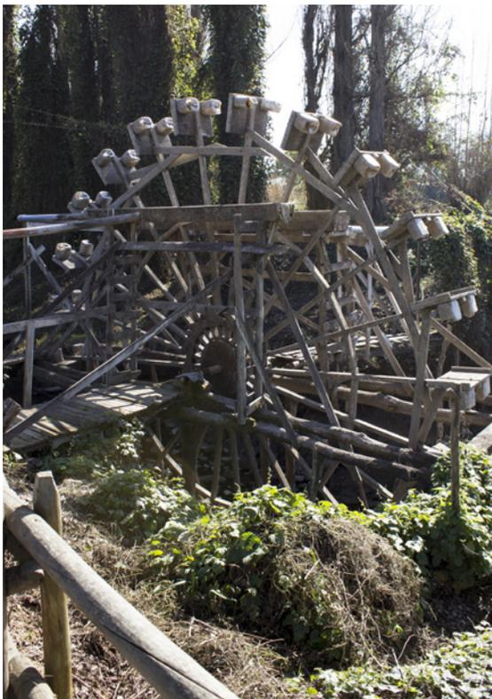
**Figura 6.** Inferior derecha. Cachos de plástico, expresado en el uso de bidones o tubos de PVC, que han ido desplazando por su durabilidad a los anteriores (Fotografía: IHP, 2012).
