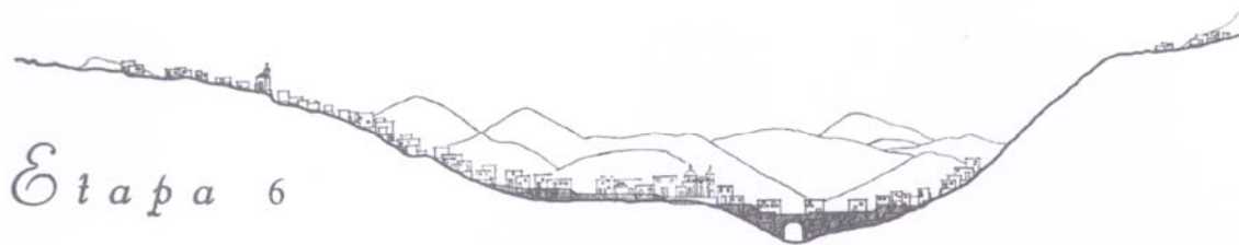
IMAGEN 6. En 1775 se decreta la elevación de la caja del río de 8 a 12 varas para proteger a la ciudad de las múltiples inundaciones. Por estas causas, se construyeron en sus riberas grandes muros de calicantos quedando parte de la ciudad enterrada. FUENTE: Archivo Histórico de la Ciudad de Guanajuato, Gto.
