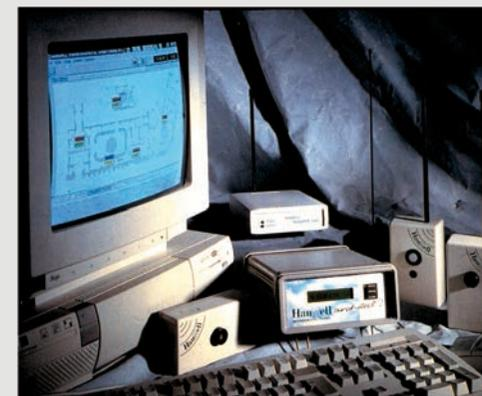
Equipos para controlar las condiciones ambientales por sistema inalámbrico.
