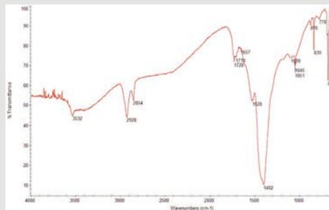
Espectro de FTIR de una muestra de pintura sobre tabla del siglo XVI: blanco de plomo (cerusita e hidrocerusita), silicatos, calcita (vestigios), óleo y carboxilatos metálicos.
