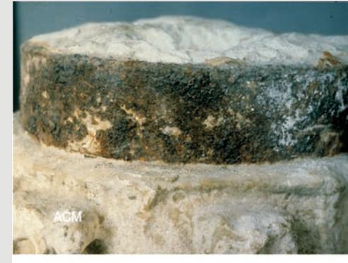
Corrosión de un elemento metálico en una escultura de piedra.
