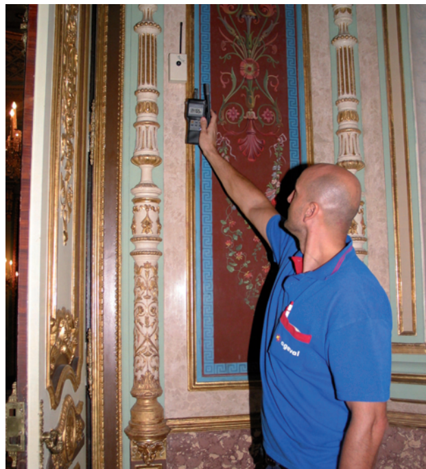
Figura 4. Trabajos de control de las mediciones de HR en sala para evaluar la precisión de la sonda remota. Foto: Museo Nacional de Cerámica y de las Artes Suntuarias “González Martí”
