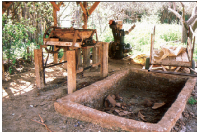
Figura 4. Máquina de moler y piscina de decantación. Foto: Jaume García Roselló.
